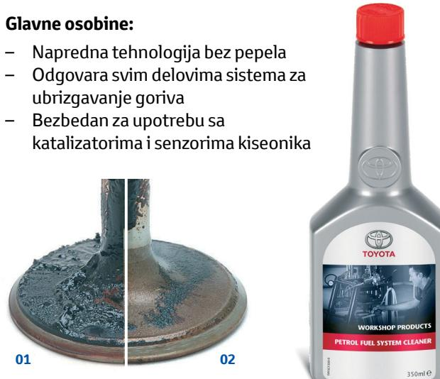
01 Skorele naslage na sedištu usisnog ventila mogu da dovedu do lepljenja, neispravnog zaptivanja i smanjene kompresije motora.
