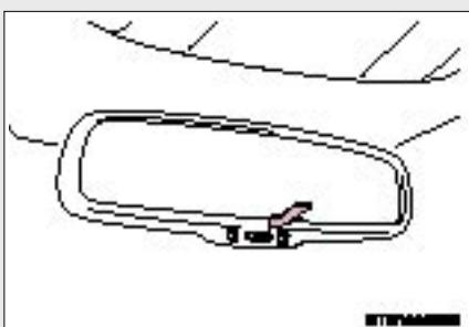
**Uključivanje/isključivanje automatskog načina rada**
