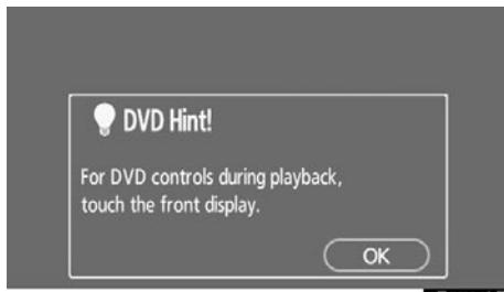
Ovaj "DVD Hint!" (Savet: Za DVD kontrole tokom reprodukcije dodirnite ekran.) ekran se pojavljuje kada je video ekran prvi put prikazan nakon postavljanja "ENGINE START STOP" prekidača u "ACCESSORY" ili "IGNITION ON" način rada.
