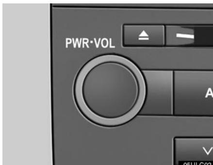
**"POWER-VOL":** Pritisnite ovo dugme za uključivanje i isključivanje audio sistema. Okrećite ovo dugme za podešavanje glasnoće. Sistem se uključuje u poslednjem korišćenom načinu rada.
