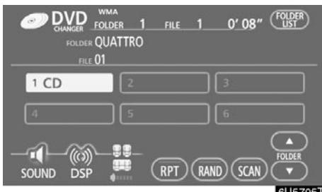
Dok traje reprodukcija diska, dodirnite "SCAN" i držite dok se "FLD-SCAN" ne pojavi na ekranu.
