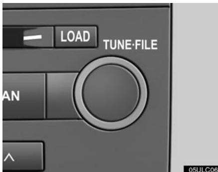
Okrenite dugme u smjeru kazaljke na satu za kretanje po opsegu frekvencija na gore, a suprotno na dole.
