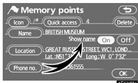
Za prikaz naziva dodirnite "On" na "Memory point" ekranu. Ako ne želite prikazivanje, dodirnite "Off".
