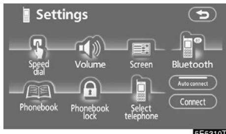
Dodirnite "Connect" (konektovanje) pošto ste omogućili Bluetooth® konekciju na telefonu.
