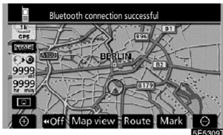
Kada je "ENGINE START STOP" prekidač postavljen na "ACCESSORY" ili "IGNITION ON ON" način rada i kada je Bluetooth® konekcija automatski uspostavljena, prikazana je provera konekcije.
