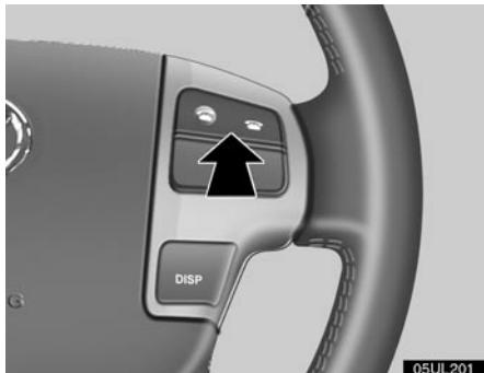
Pritiskanjem prekidača telefona prikazanog iznad, možete primiti poziv ili prekinuti vezu, bez skidanja ruku sa upravljača.
