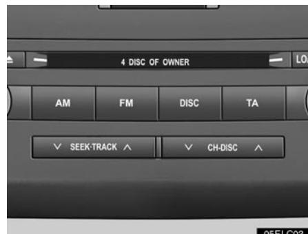
Pritisnite "AM", "FM" ili "DISC" dugme da biste uključili željeni način rada. Odabrani način rada odmah se uključuje.
