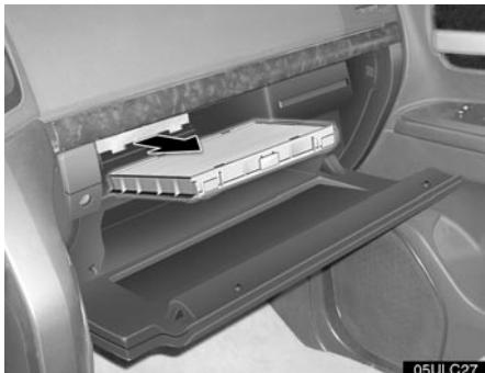
**3. Izvadite kućište filtera.**
