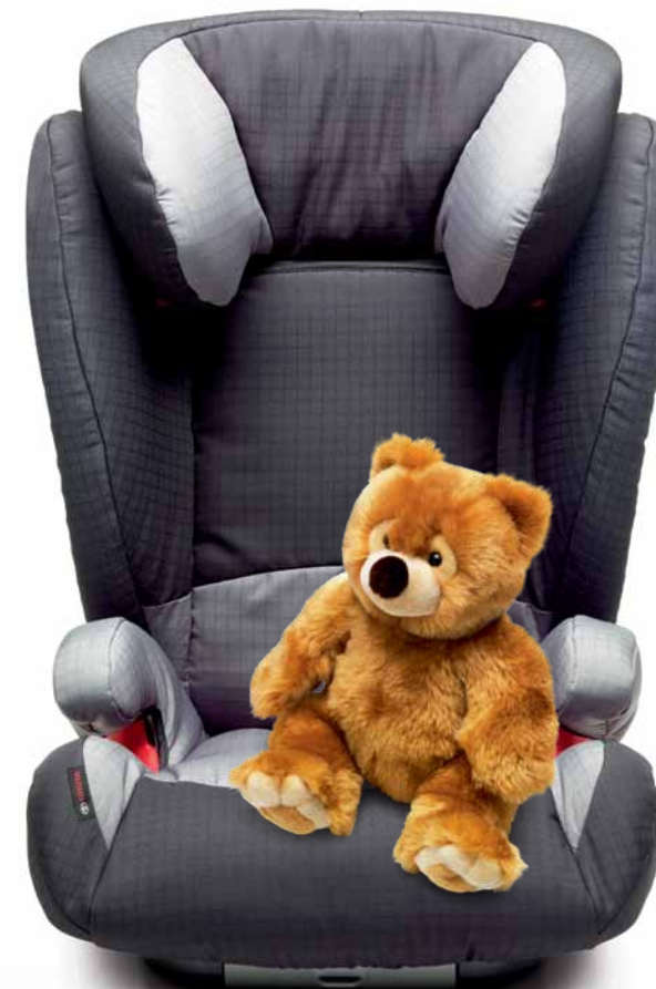
Otroška sedeža Kid in Kidfix Po višini nastavljiv sedež za otroke med 4. in 12. letom starosti (približno 15-36 kg). Model Kidfix je opremljen s sistemom za pritrditev ISOFIX.
