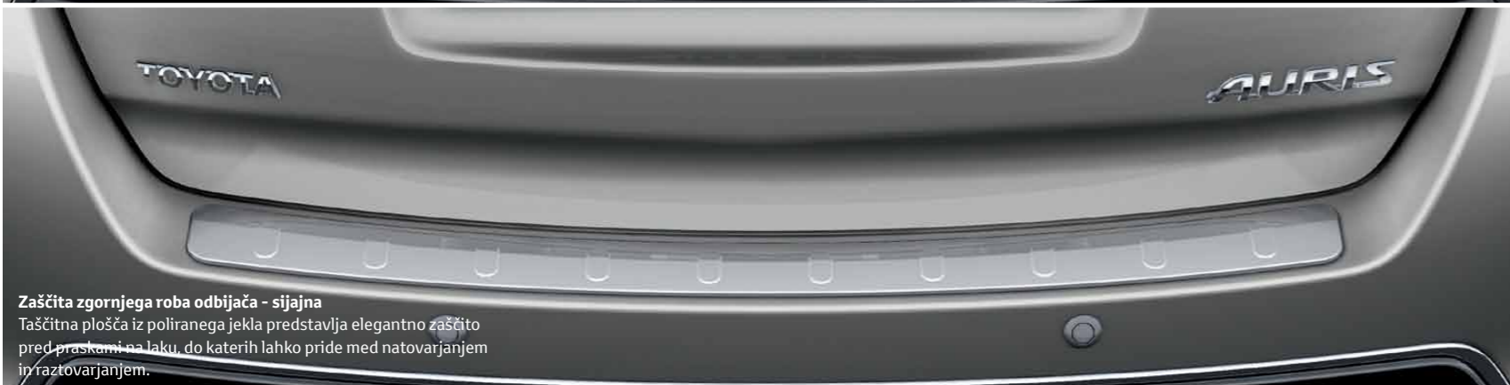
Zaščita zgornjega roba odbijača - brušena Zaščitna plošča ščiti lak na zadnjem odbijaču pred praskami, do katerih lahko pride med natovarjanjem in raztovarjanjem. S površino iz brušenega jekla.
