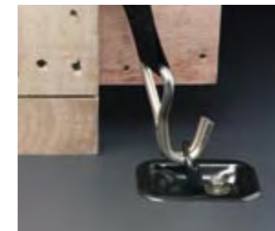
Varnostna sidra za pritrditev tovora Pritrdišča so na voljo po celotnem tovornem prostoru.
