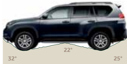
Vstopni, prehodni in izstopni kot
