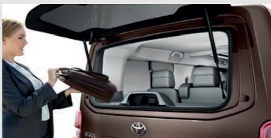
Staklo poklopca prtljavnika otvara se zasebno – što je standardna oprema na paketima opreme Family i VIP – nudeći brz i olakšan pristup prtljniku bez potrebe za otvaranjem poklopca prtljavnika.
