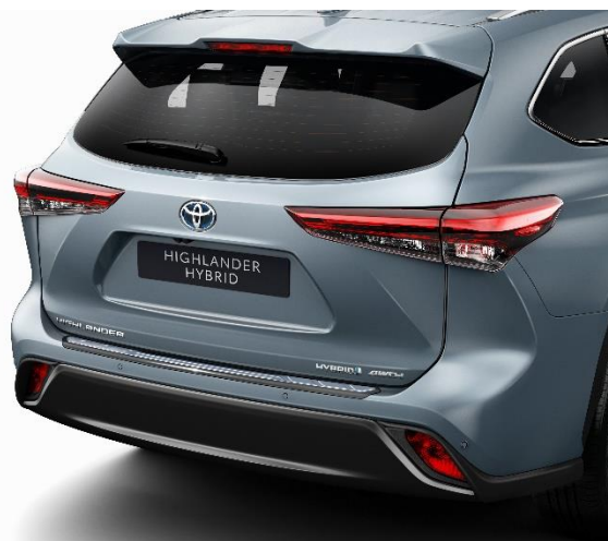
2. Zaštitna lajsna zadnjeg branika – nerđajući čelik
