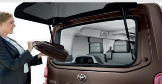
Staklo poklopca prtljažnika otvara se zasebno – što je standardna oprema na paketima opreme Family i VIP – nudeći brz i olakšan pristup prtljažniku bez potrebe za otvaranjem poklopca prtljažnika.
