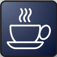
Upozorenje za pozornost vozaču pokreće vizualno i zvučno upozorenje kada utvrdi da se vozilo nije zaustavilo dva sata krećući se brzinom iznad 65 km/h. Radi dodatne zaštite, sustav otkrivanja umora (Fatigue Detection System) prati promjene u položaju vozila na cesti i podiže razinu upozorenja vozaču na „Odmori se!“.
