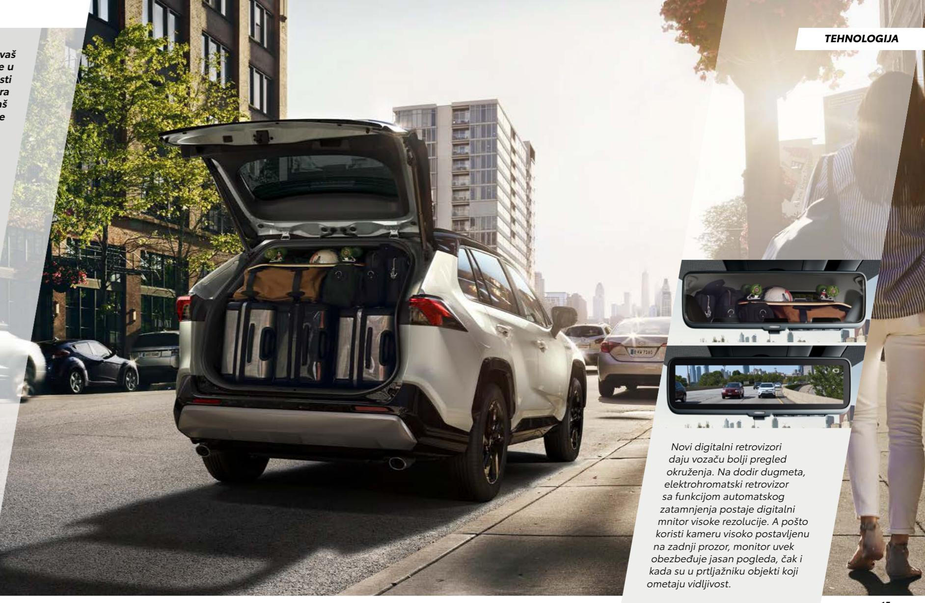
Novi digitalni retrovizori daju vozaču bolji pregled okruženja. Na dodir dugmeta, elektrohromatski retrovizor sa funkcijom automatskog zatamnjivanja postaje digitalni monitor visoke rezolucije. A pošto koristi kameru visoko postavljenu na zadnji prozor, monitor uvek obezbeđuje jasan pogled, čak i kada su u prtljažniku objekti koji ometaju vidljivost.
