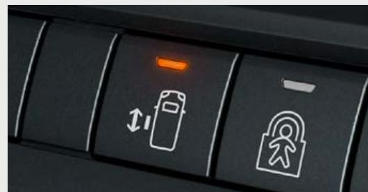
Električna klizna vrata na PROACE VERSO uključuju se jednostavnim povlačenjem unutrašnje ili spoljašnje kvake vrata. Ovu funkciju moguće je uključiti i pritiskom na dugme na ključu, na kontrolnoj tabli ili na srednjem stubu – ulazak ili izlazak sa zadnjih sedišta nikada nije bio jednostavniji.
