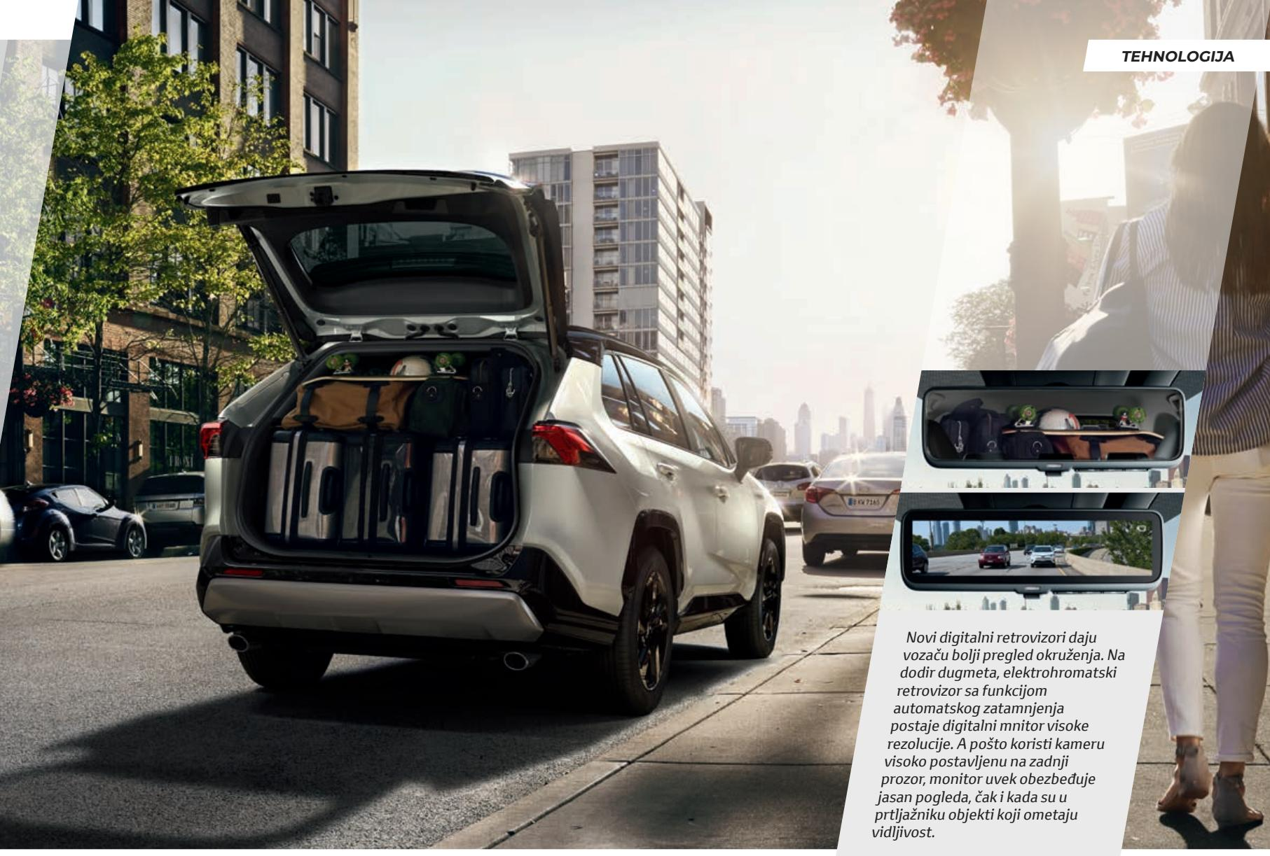
Novi digitalni retrovizori daju vozaču bolji pregled okruženja. Na dodir dugmeta, elektrohromatski retrovizor sa funkcijom automatskog zatamnjivanja postaje digitalni monitor visoke rezolucije. A pošto koristi kameru visoko postavljenu na zadnji prozor, monitor uvek obezbeđuje jasan pogleda, čak i kada su u prtljažniku objekti koji ometaju vidljivost.
