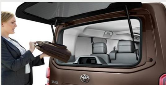
Zaščitno steklo prtljažnega prostora se odpira ločeno - je standardna oprema pri paketu opreme Family in VIP- ponuja hiter in lažji dostop do prtljažnika brez potrebe po odpiranju vrat.
