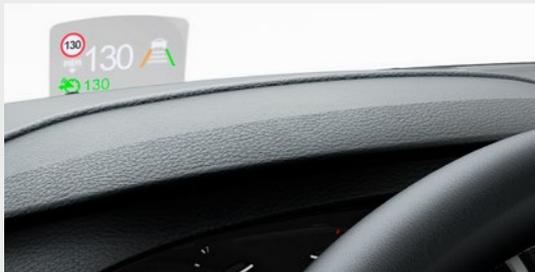
Napredno virtualni zaslon prikazuje vrsto podatkov - od trenutne hitrosti do navodil za navigacijo in opozoril vozniku - na sprednji strani vetrobranskega stekla v vidnem polju voznika.
